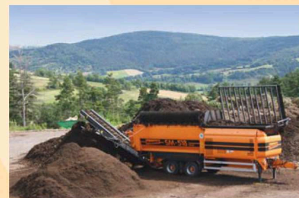
Criblage du compost
