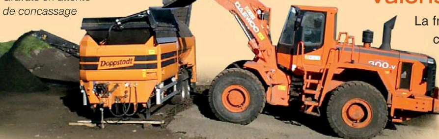
Criblage des matériaux
